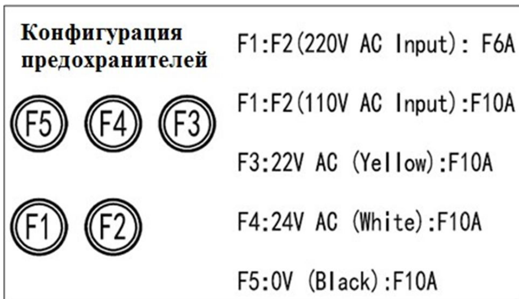
Рис. 6 Блок предохранителей напольного блока подключения
