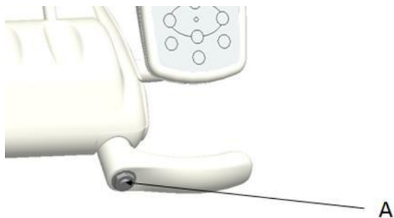
А: Пневмотормоз на модуле врача с верхней подачей
